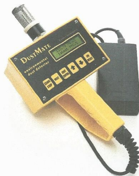
Слика бр. 1; Инструмент за мерење на ниво на Квалитет на воздух - определување на вкупни суспендирани честици, респирабилни честици и фракција на ПМ 10 и ПМ 2.5 честици - тип TURNKEY DustMate kit
