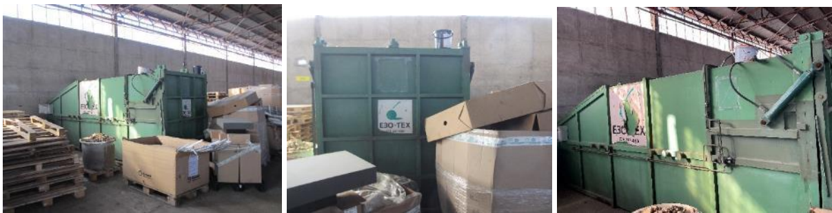
Слика 18: Изглед на опрема потребна за преработка на отпадот во инсталацијата - балирка)
