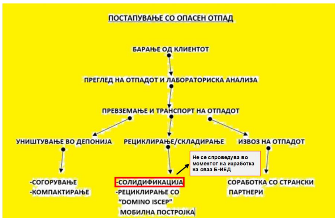
Слика 9: Шема на постапување и управување со опасен отпад во инсталацијата “ЕЗО-ТЕХ”
