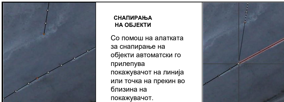
Слика27.Снапирање на објекти
