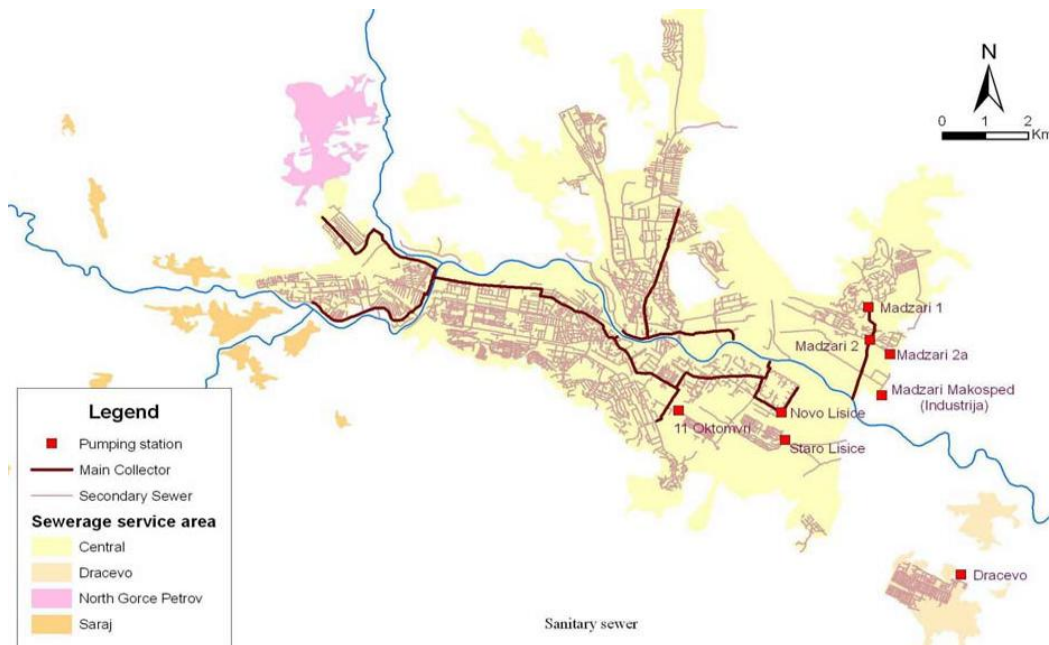
Слика 4. Постојна состојба на канализациониот систем
