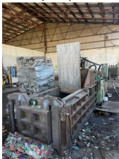
Сила на притисок: 80 – 150 t; Погон: Електромотор: 15- 30 Kw; Напон: 380–400V, 50Hz Работен притисок: 80 – 250 bar; Тежина на бала: 300 – 700 kg (зависно од материјал).
