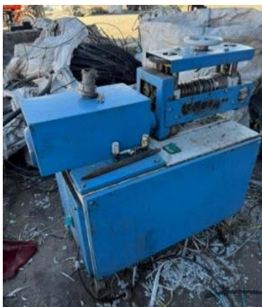
Производител: FASAMAK, Моќност на мотор: 2.2 – 5.5 kW, Напојување: 380V / 50Hz (трофазно), Тип управување: Механичко Тежина: 250 – 500 kg.
